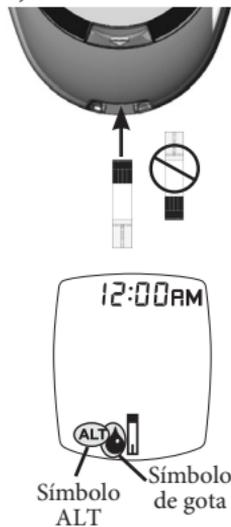
**Nota:** Si se dejó una tira fuera del envase por mucho tiempo antes de realizar la prueba, aparece un mensaje de error cuando se la introduce en el medidor. Saque la tira vieja y deséchela. Use una nueva para realizar la prueba.
